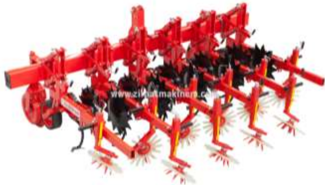
Слика 5: Култиватор за отстранување на плевел со диск и игли за пळेње
